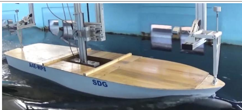
Figura 1: Modelul experimental în timpul încercărilor în bazinul de rezistență la înaintare din Universitatea Dunărea de Jos din Galați
